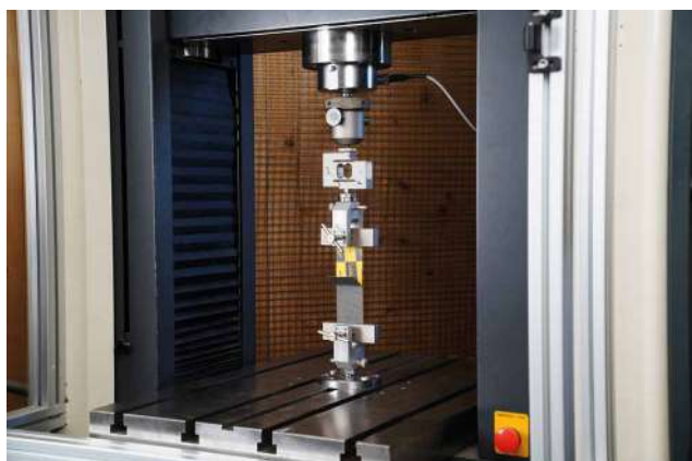
Серия испытаний по проверке когезии и адгезионных свойств акриловых клейких лент на различных основаниях.
